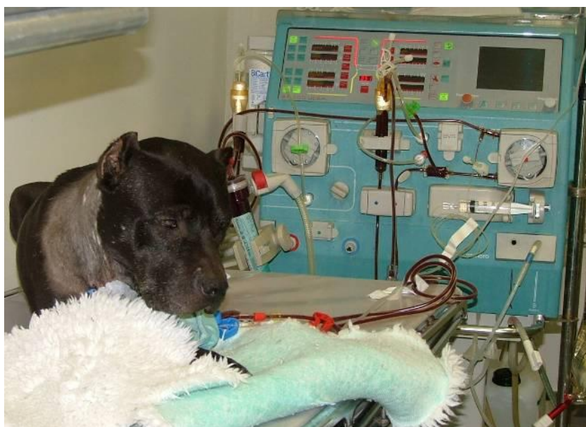
Fig n° 4. Macchina da emodialisi intermittente: si evidenziano le linee, che passano attraverso le elettropinze, la pompa sangue, sotto la quale si vede la pompa-siringa per la somministrazione continua di eparina, il gocciolatore della linea venosa, che riporta il sangue al paziente, ed i due trasduttori di pressione per la linea arteriosa e venosa.(Gambro AK 200S).
